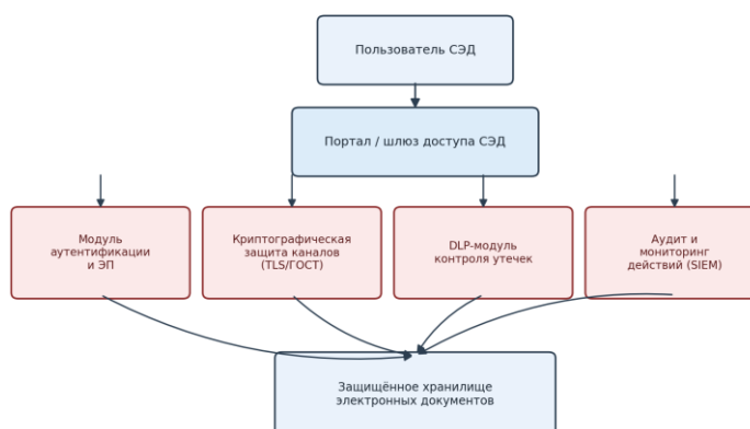
Рисунок 1 - Архитектура защищённой системы электронного документооборота
