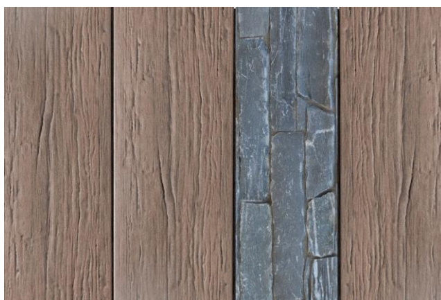
Рисунок 5 – Макрофотография текстуры современного ДПК, имитирующей породы дерева с 3D-эффектом фактуры
