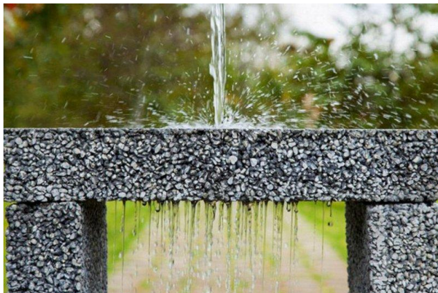
Рисунок 3 – Водопроницаемый (дренирующий) бетон
