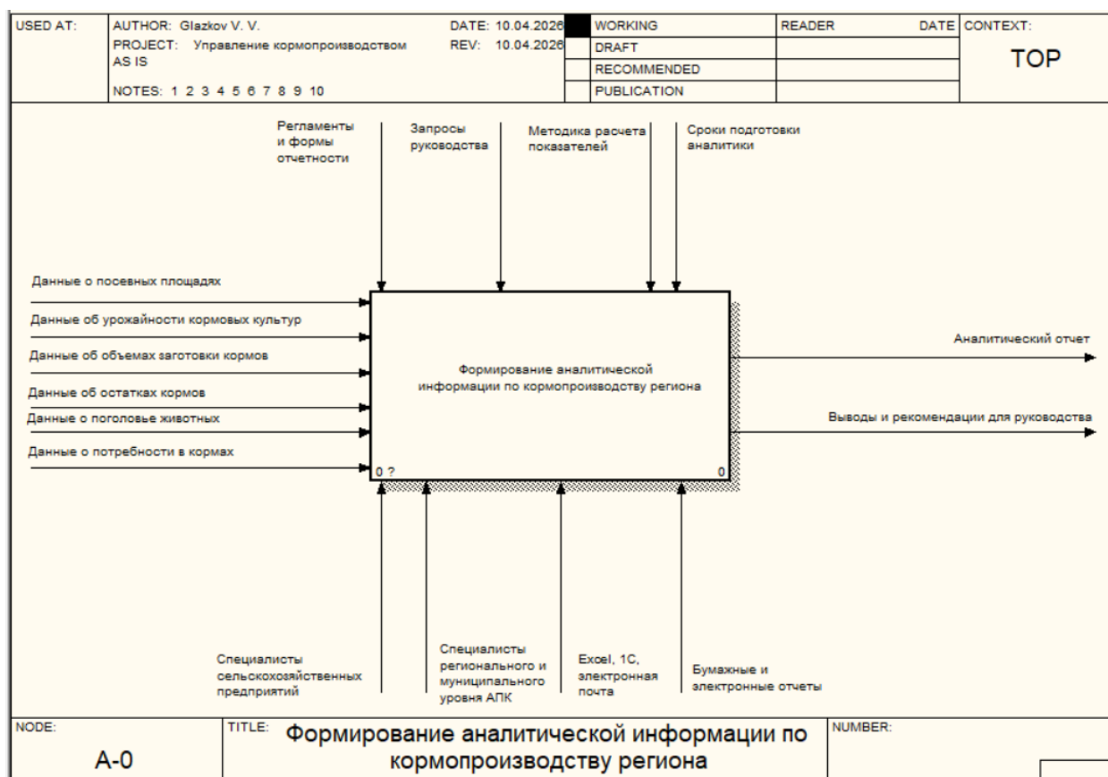
Рисунок 1 – Контекстная диаграмма процесса формирования аналитической информации по кормопроизводству региона (AS IS)
