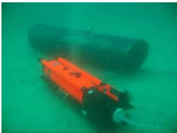
Рисунок 1 – Обнаружение донной мины с помощью ДУНПА
