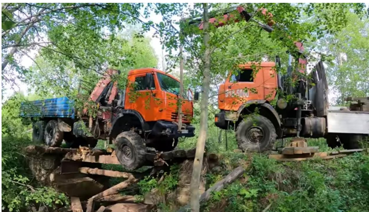
Рис. 4 - Выполнение эвакуационных работ манипулятором
