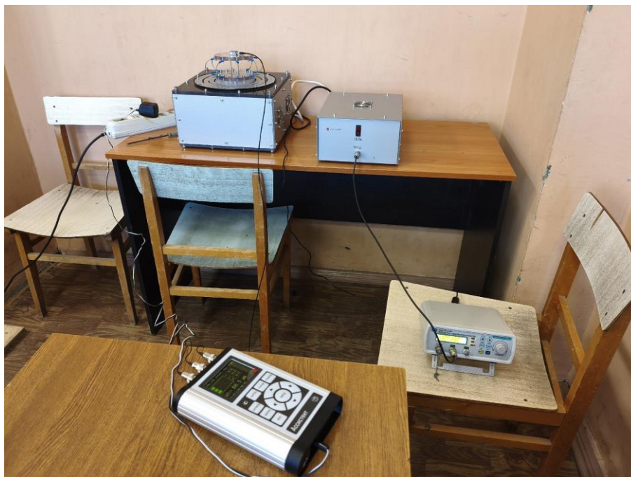
Рисунок 1 – Лабораторный стенд «Исследование способов защиты от производственной вибрации» БЖД-15
