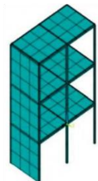
Рисунок 5 - Конечно-элементная модель рамной конструкции со стенами жесткости в программной среде ANSYS
