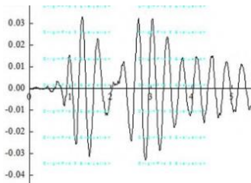
Рисунок 3 - Временной график горизонтального смещения верхней точки здания при пиковом ускорении 0,6 g представлен
