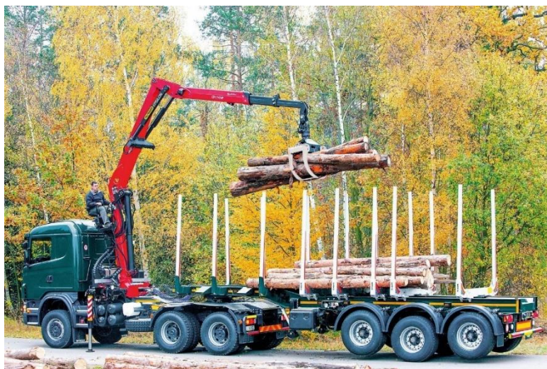
Рисунок 1 — Гидроманипулятор с шарнирно-сочленённой Z-образной компоновкой стрелы
