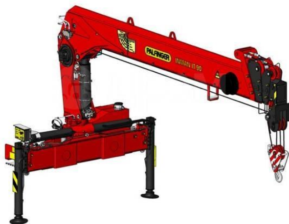
Рисунок 2 — Гидроманипулятор с шарнирно-сочленённой L-образной компоновкой стрелы
