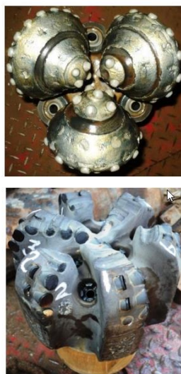
Рисунок 7 – Типичный износ в окремнениях на площадях Пермского края
