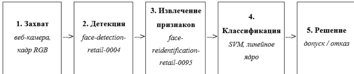
Рисунок 1 - Функциональная схема системы распознавания лиц
