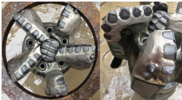
Рисунок 3 – Фото долота ES55RKS после первой работы на Речицком месторождении
