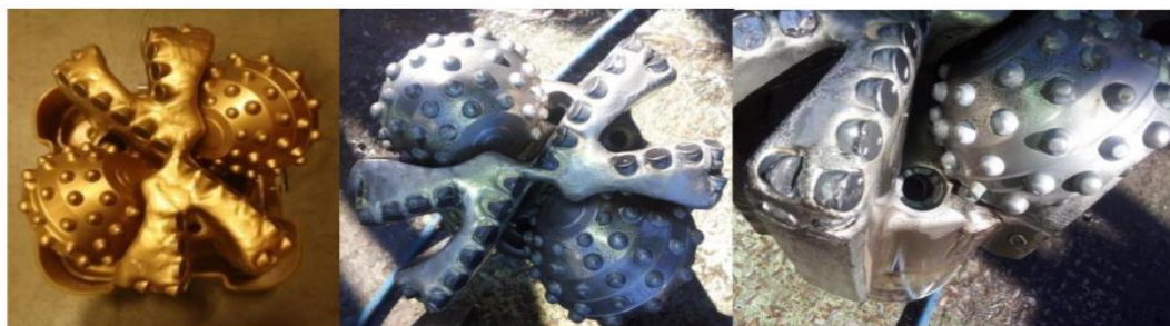
Рисунок 2 – Состояние долото до и после рейса
