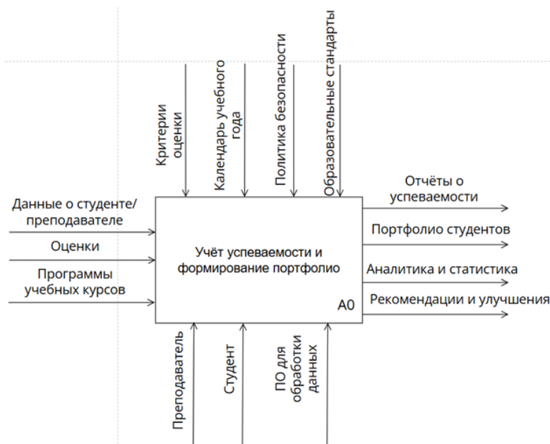
Рисунок 1 – Диаграмма IDEF0: процесс учёта успеваемости и формирования портфолио (A0)
