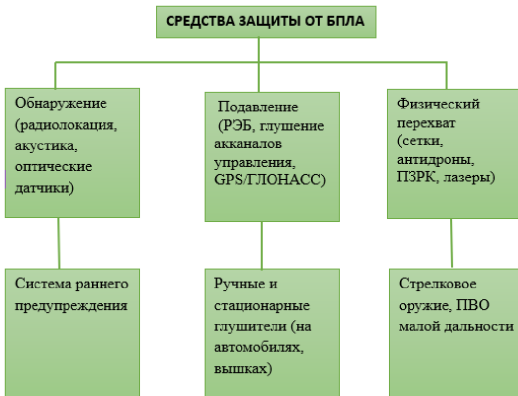
Рисунок 1 – Эшелонированная система защиты от беспилотных летательных аппаратов
