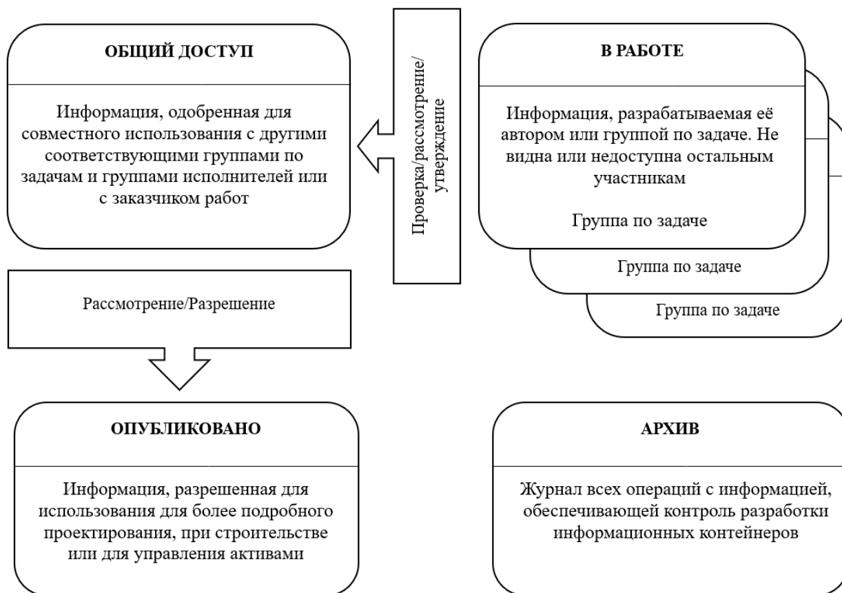
Рисунок 1 – Принципиальная схема обмена информацией внутри СОД
