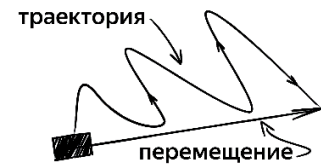
Рисунок 2 – Графическое объяснение понятий «перемещение», «путь» и «траектория»
