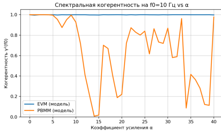
Рисунок 2 - Спектральная когерентность \gamma^2(f_0) между эталонным и выходным сигналами в зависимости от \alpha
