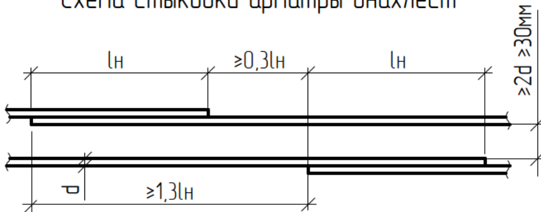
Рисунок 3 - Схема стыковки арматуры внахлест
