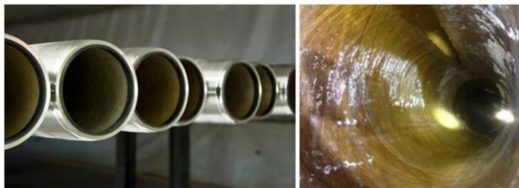
Рисунок 3 – Футеровка труб из углеродистой стали материалами GRE
