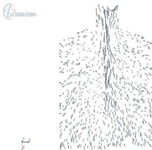
Рисунок 6 – Поле скорости в осевом сечении – проекция, составляющая поля скорости в осевом направлении разрез, б - изолинии величины скорости
