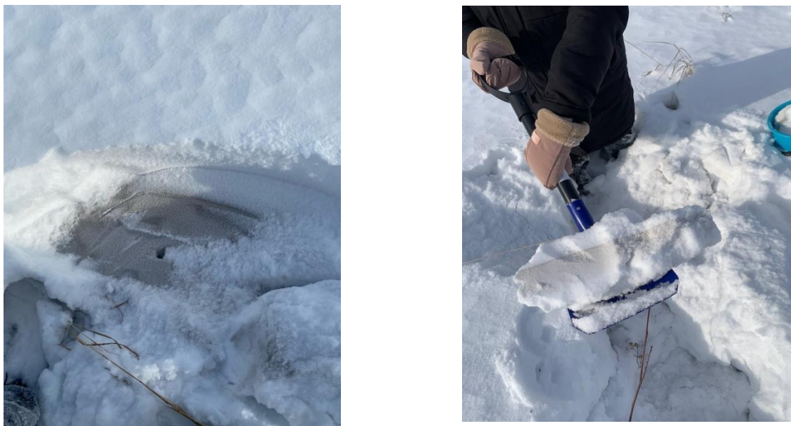
Рис. 1. Слой угольной пыли под слоем свежеснегавпавшего снега в зоне воздействия предприятия открытой перевалки угля
