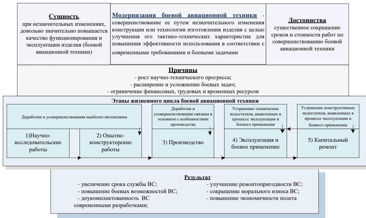
Рисунок 1 - Сущность, причины и достоинства модернизации БАТ на всех стадиях жизненного цикла БАТ
