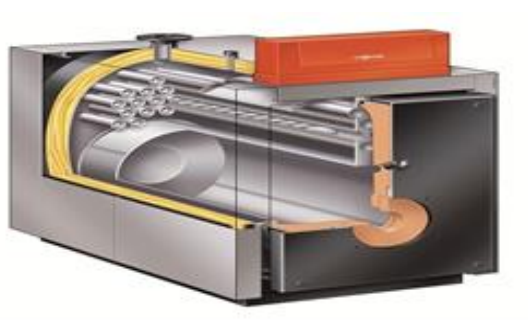
Рис. 1. Схема газоходного тракта двухходового котла с реверсивной топкой
