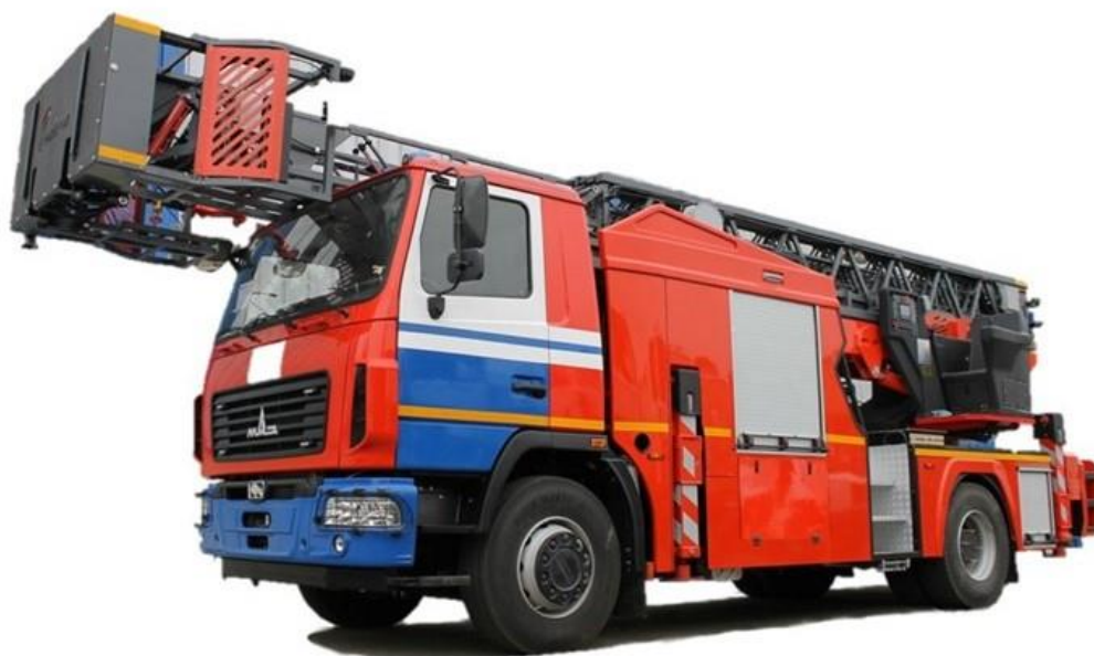
Рисунок 2 – АЛ-32 на базе шасси МАЗ-5340С3
