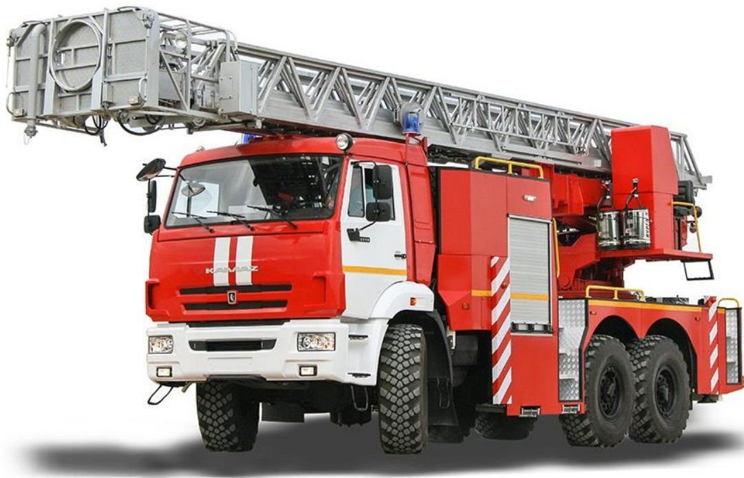
Рисунок 3 – АЛ-32 на базе шасси КамАЗ 43118
