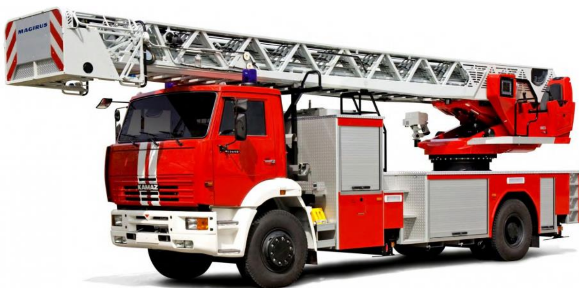
Рисунок 1 – АЛ-32 на базе шасси КАМАЗ 53605
