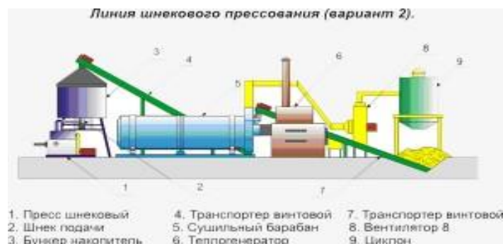
Рисунок 1 – Схема линии по производству пеллет
