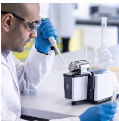
Рисунок 1 - Многофункциональный настольный прибор Cary 630 FTIR
