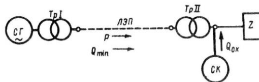
Рис. 3. Схема включения синхронного компенсатора (СК) в электрическую систему [3]
