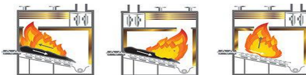
Рисунок 2 - Принципиальные схемы слоевого сжигания на колосниковой решетке (слева направо): противоточная, прямоточная, перекрестная
