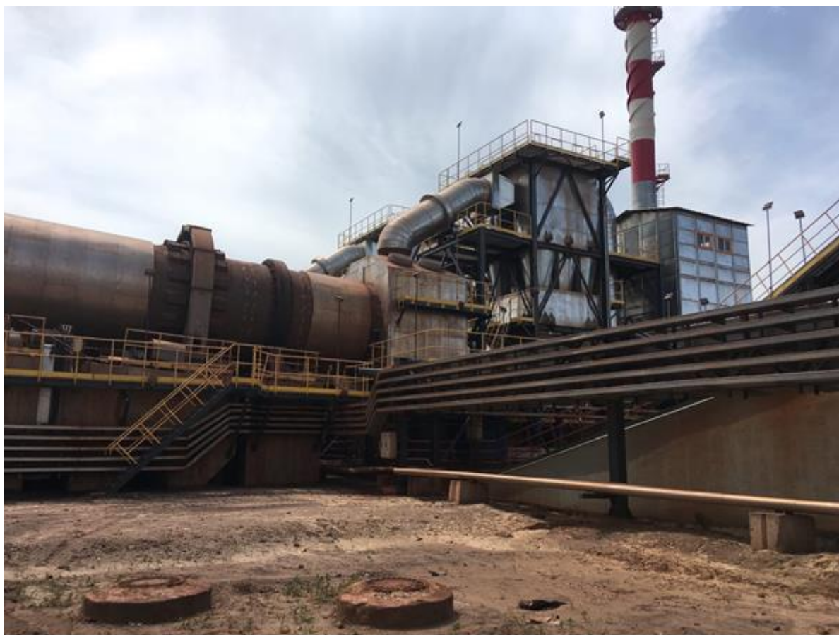
Рисунок 1 - Блоки циклонов из восьми штук за двумя линиями барабанных сушилок Яковлевского горно-обогатительного комбината
