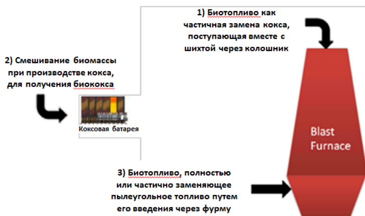
Рисунок 1 – Способы подачи биомассы в доменную печь
