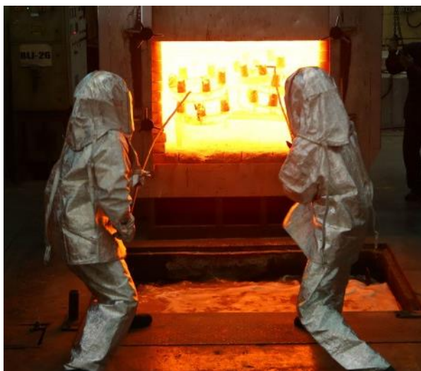
Рисунок 1 – Закалка алюмелевого сплава
