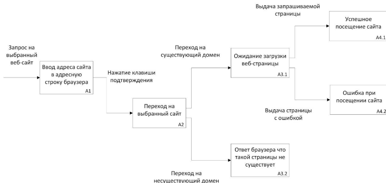
Рисунок 1 - Диаграмма последовательности ручного мониторинга доступности сайта
