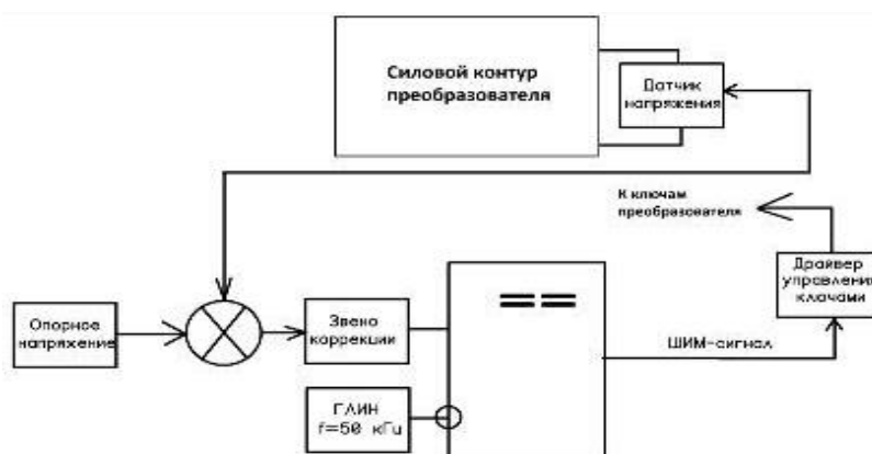
Рисунок 2 – Функциональная схема преобразователя с системой управления по выходному напряжению
