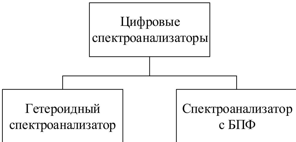
Рисунок 3 — Классификация цифровых анализаторов спектра
