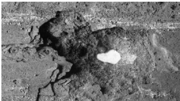
Рисунок 1 – Внутренняя поверхность НКТ \text{Ø}73 \times 5,5 мм из стали 35Г2С после 120 суток эксплуатации в скважине с повышенным содержанием \text{CO}_2
