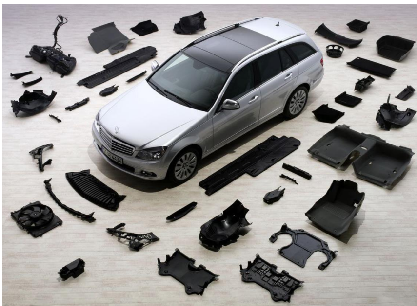
Рисунок 1 - Детали из ПКМ кузова автомобиля
