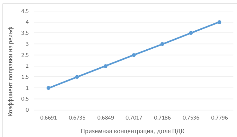
Рисунок 1 – Зависимость приземной концентрации пыли от коэффициента, учитывающего рельеф местности
