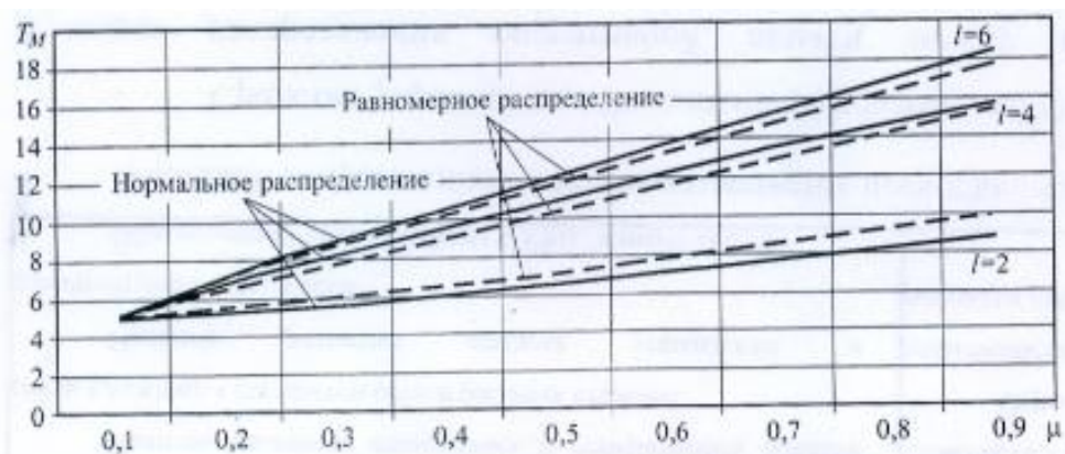
Рис. 1 - Зависимость T_M = f(\mu) для двух законов распределения наступления отсчетов диагностической информации с ЭМС
