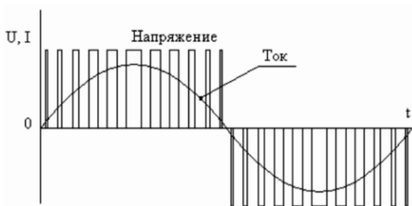
Рисунок 2 – Форма тока и линейного напряжения на выходе преобразователя частоты
