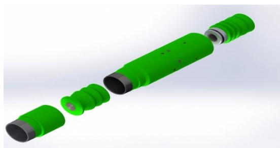
Рисунок 2 – Муфта ступенчатого цементирования скважины [6]
