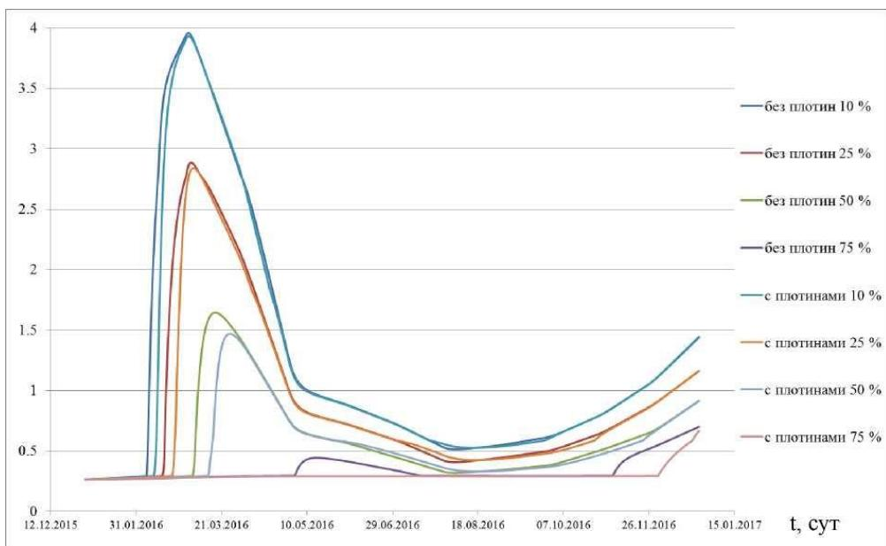
Рис 1. Графики расходов в створе Соколовского водохранилища при различных сценариях
