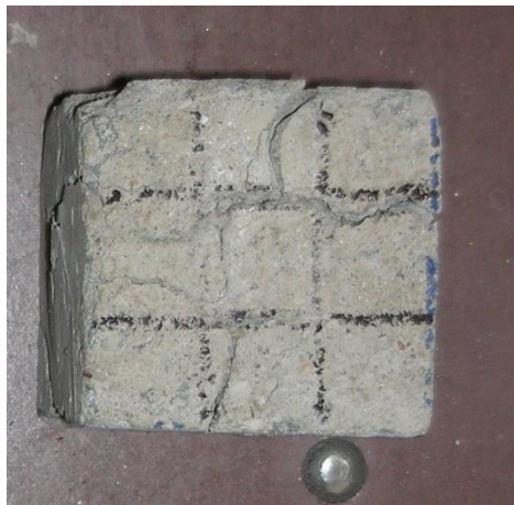
Рисунок 2. Образец после испытания на местное смятие при центрально приложенной нагрузке
