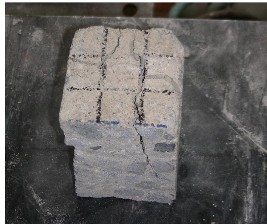
Рисунок 2. Образец после испытания на местное смятие при центрально приложенной нагрузке
