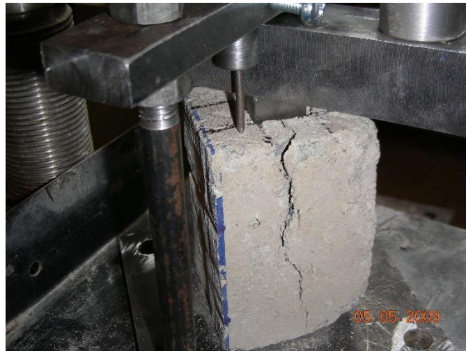
Рисунок 1. Образование трещины в момент испытания
