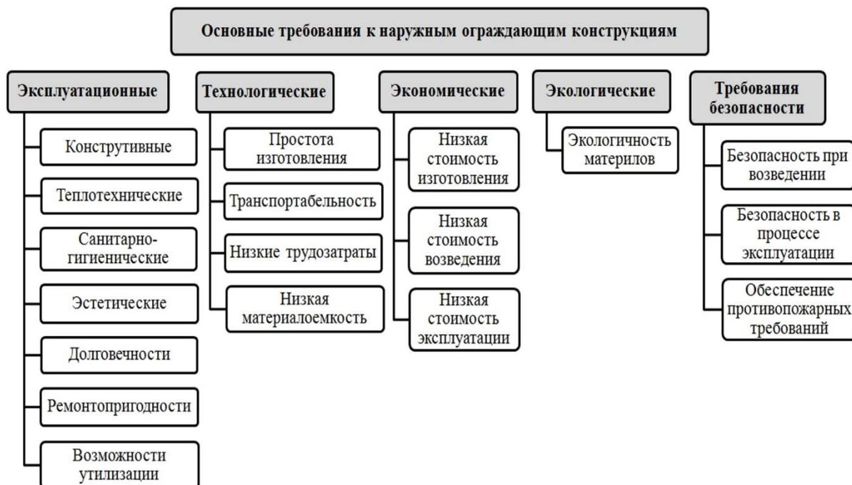
Рис. 1. Требования к наружным ограждающим конструкциям
