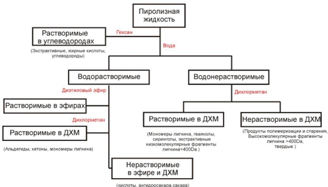
Рисунок 2 - Схема сепарации пиролизной жидкости растворителями
