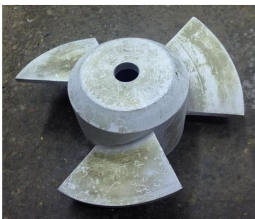
Рис. 1 – Отливка типа винт
